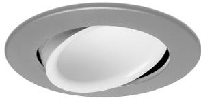
Downlights Empotrables: Tiny. Cuerpo disipador de aluminio inyectado y lacado con resinas poliéster de alto rendimiento mediante aplicación electrostática y posterior polimerizado, resistente a los rayos UV y a la corrosión. Reflector y bridas en inyección de policarbonato técnico de alta reflexión. Difusor: Sin difusor. Acabado: Gris.
