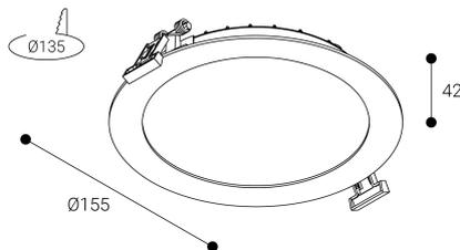
Instalación: Mantener una distancia mínima de seguridad de 50 mm entre el equipo y el techo para garantizar su correcto funcionamiento.
